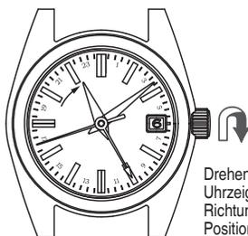
Drehen der Krone im Uhrzeigersinn (in Richtung der 12-Uhr-Position): Der Stundenzeiger wird um eine Stunde vorgestellt.
