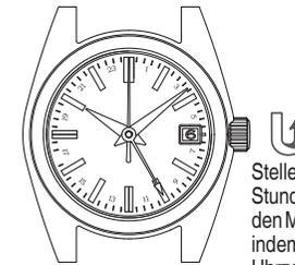
Stellen Sie den 24-Stundenzeiger und den Minutenzeiger ein, indem Sie sie im Uhrzeigersinn drehen.
