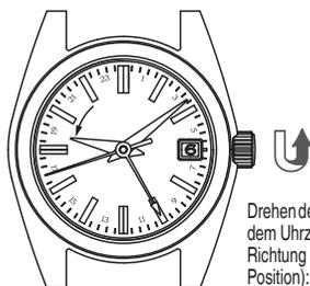
Drehen der Krone entgegen dem Uhrzeigersinn (in Richtung der 6-Uhr-Position): Der Stundenzeiger wird um eine Stunde zurückgestellt.
